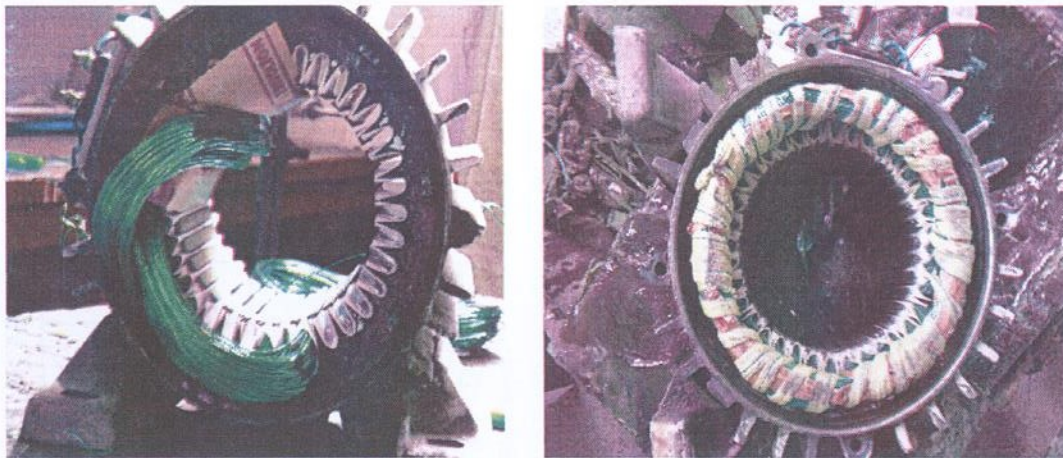
Figura 3 Pamje nga avolxhimi i motorit asinkron të përdorur në eksperiment.
